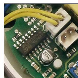
Versione HT con circuito elettronico a microprocessore
