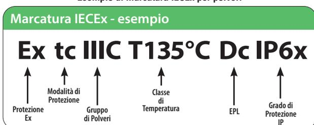
NB: EPL: livello di protezione delle apparecchiature
