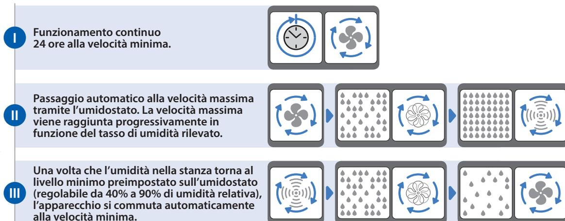
Anche la versione Igrostatato è dotata di un timer regolabile da 0 a 30 minuti per l'attivazione tramite comando remoto della velocità massima. La funzione è utile quando si crea la necessità di far funzionare l'apparecchio a pieno regime indipendentemente dal livello di umidità della stanza (vedasi punto III versione standard).
