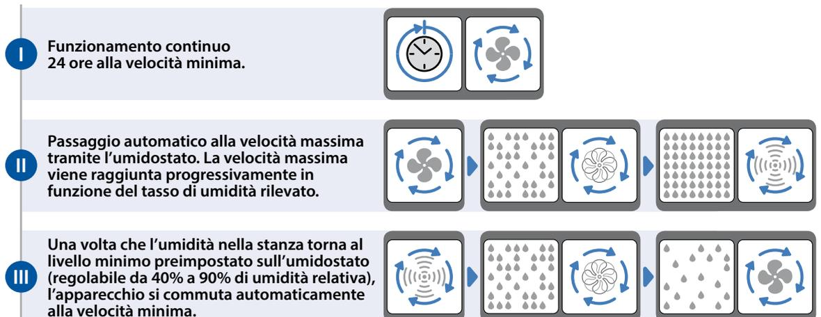
Anche la versione Igrostat è dotata di un timer regolabile da 0 a 30 minuti per l'attivazione tramite comando remoto della velocità massima. La funzione è utile quando si crea la necessità di far funzionare l'apparecchio a pieno regime indipendentemente dal livello di umidità della stanza (vedasi punto III versione standard).
